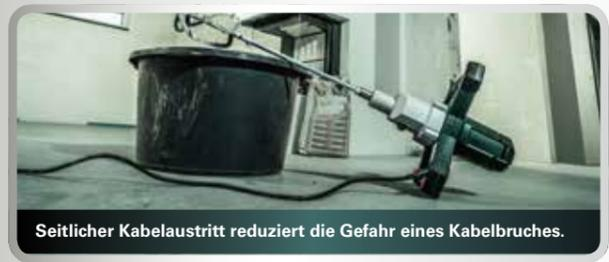
Seitlicher Kabelaustritt reduziert die Gefahr eines Kabelbruches.
