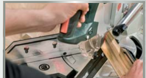
Doppellinienlaser zur exakten Anzeige der Schnittlinie links und rechts vom Sägeblatt
