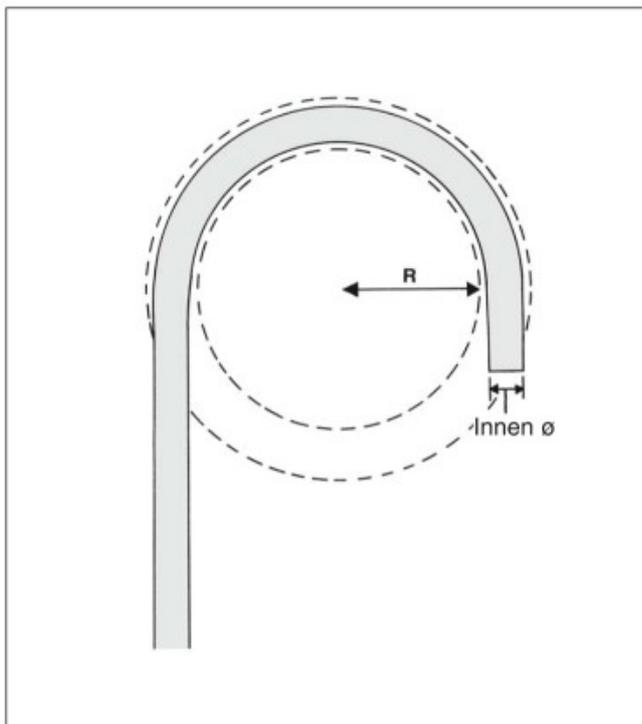
**Biegeradius:** „R“ ist der Strahl vom kleinstmöglichen Kreis in dem der Schlauch gebogen werden kann, ohne zu knicken.
